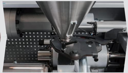
Elektrisch verfahrbarer Materialtrichter / -förderer zum einfacheren Nachfüllen
